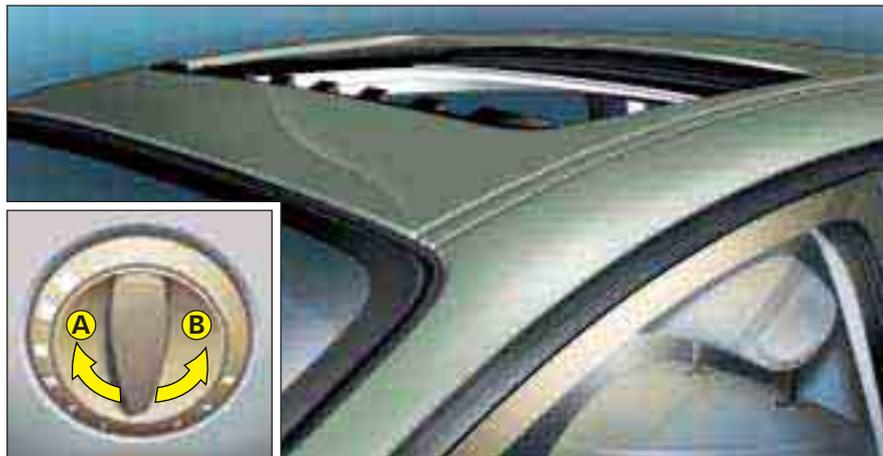
Uzavření střešního okna je automatické při uzavření oken vozidla stisknutím tlačítka pro ovládání oken na dálkovém ovladači. Systém ochrany proti sevření přeruší zavírání okna, pokud se objeví v jeho dráze překážka; následně se okno otevře.
