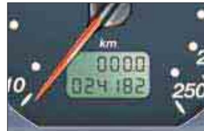
Po zapnutí klíče jsou údaje o proběhu zobrazeny znovu až po zobrazení údajů o množství oleje v motoru a intervalu údržby.
