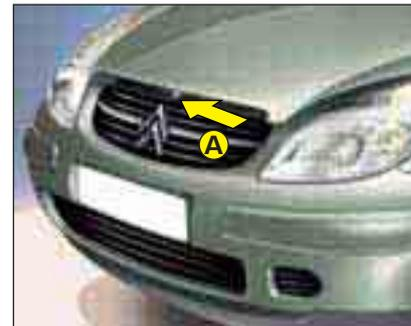
Pojistný hák **A** umístěný uprostřed přední části víka odjistíte a víko nadzdvihnete.
