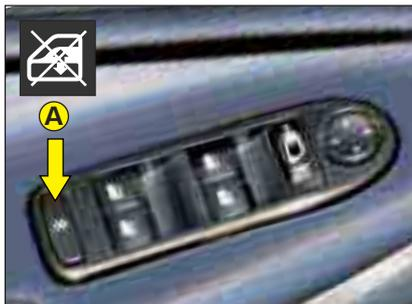
**Poznámka:** Za deště se elektricky vřádaná okna automaticky uzavřou. Uzavřerí lže zrušit stisknutím ovládacího tlačítka na dveřích řidiče nebo spolujezdce.
