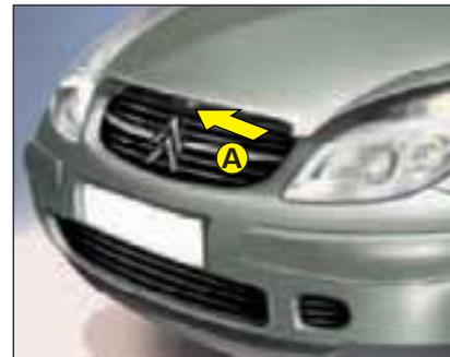
Pojistný hák **A** umístěný uprostřed přední části víka odjistěte a víko nadzdvihněte.
