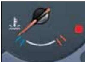
**Ukazatel teploty chladicí kapaliny.****Výstražná kontrolka teploty a množství chladicí kapaliny**
