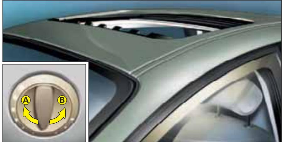
Uzavření střešního okna je automatické při uzavření oken vozidla stisknutím tlačítka pro ovládání oken na dálkovém ovladači.
