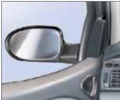
Pokud dojde k posunutí tělesa zrcátka z jeho základní polohy u stojícího vozidla, lze jej vrátit do správné polohy ručně nebo pomocí elektrického ovládání sklápění zpětných zrcátek.
