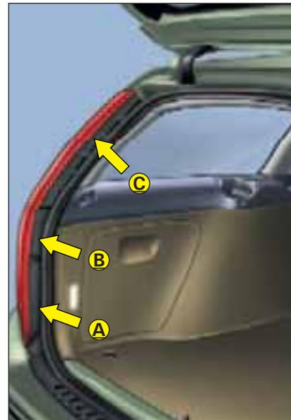
Po výměně namontujte nejprve horní část a poté spodní.
