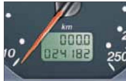
Po zapnutí klíčku jsou údaje o proběhu zobrazeny znovu až po zobrazení údajů o intervalu údržby a množství oleje v motoru.
