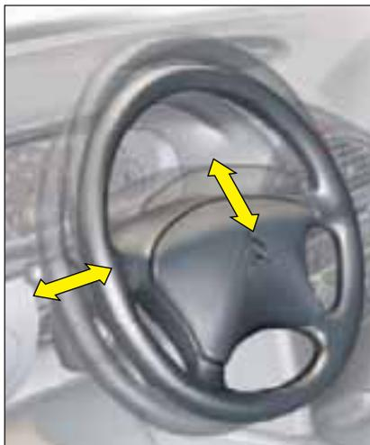
Odblokujte volant zatlačením ovládací páky směrem dopředu.
